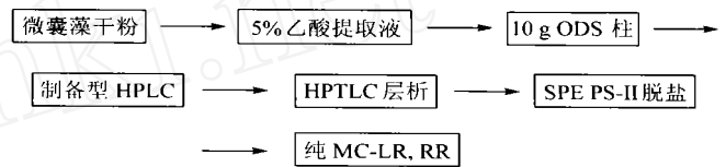
图2 微囊藻毒素纯化工艺流程
